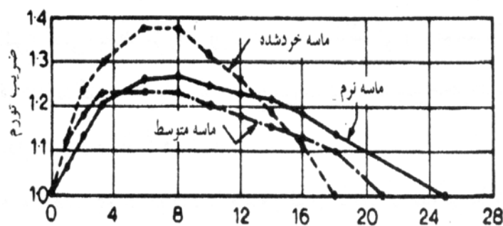
شکل ۲ اثر رطوبت ماسه در حجم بتن (به عنوان مثال)
